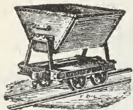
Wagon type 22, pour terrassement.
